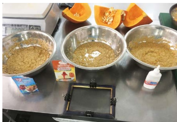
Рисунок 2. Замес ингредиентов для бумаги из отходов тыквы.
